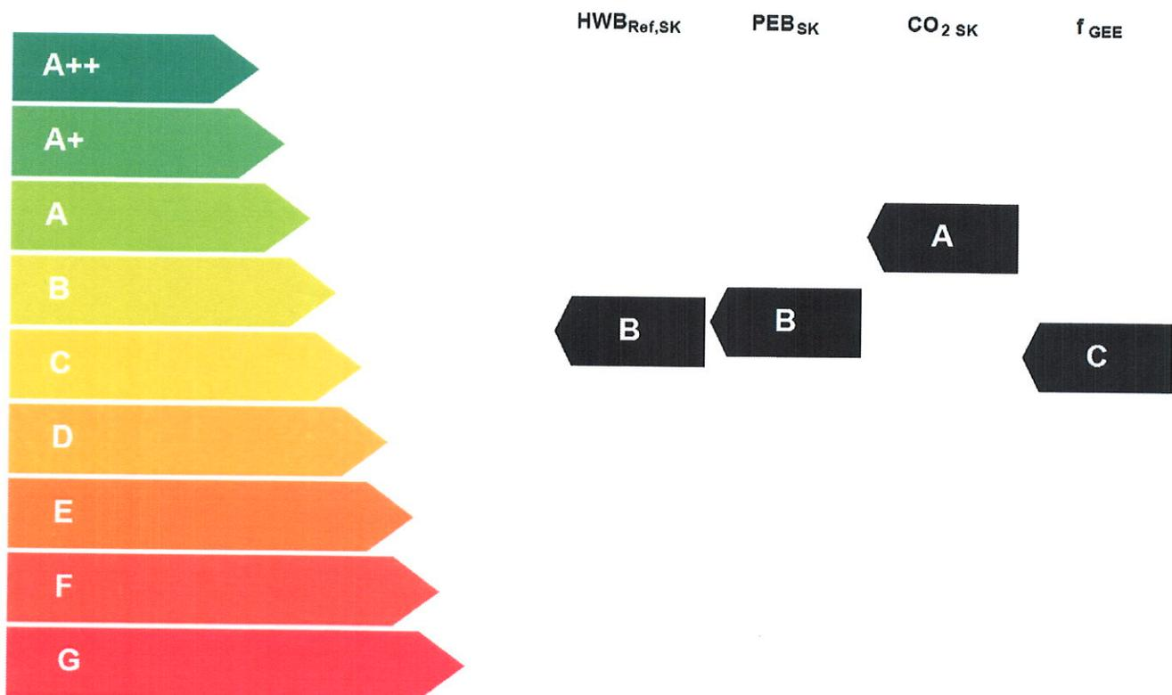
**$HWB_{Ref}$** : Der Referenz-Heizwärmebedarf ist jene Wärmemenge, die in den Räumen bereitgestellt werden muss, um diese auf einer normativ geforderten Raumtemperatur, ohne Berücksichtigung allfälliger Erträge aus Wärmerückgewinnung, zu halten.
